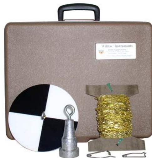
Kit « Sondage » avec son disque de Secchi et le plomb de sondage regroupés en une valise de terrain
