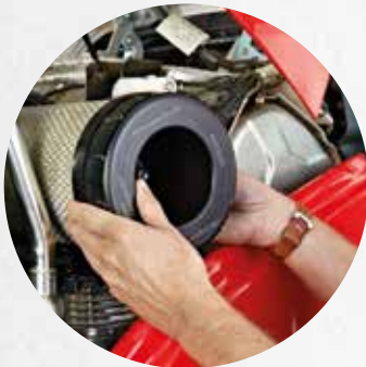
Un nettoyage continu au moyen d'un filtre Piclon garantit que le filtre n'a besoin d'être entretenu que si le voyant correspondant s'allume.
