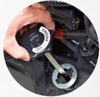
Vérification du niveau d'huile et recharge d'huile sans soulever le capot du moteur.
