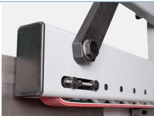
Un ruban transporteur au lieu de rouleaux presseurs facilite considérablement le ponçage des petites pièces.
