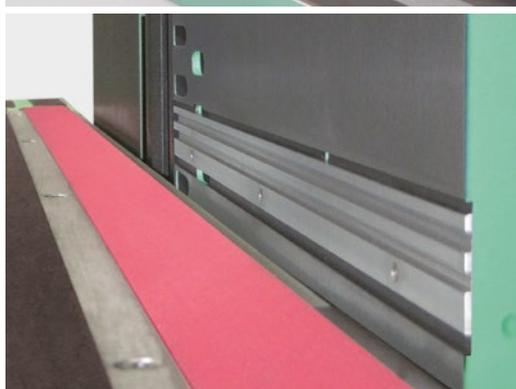
La butée d'entrée rainurée permet le ponçage des chants avec des saillies de placage.
