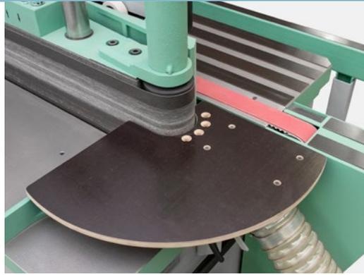
Table demi-ronde pour le ponçage des pièces échancrées contre le rouleau d'entraînement caoutchouté
