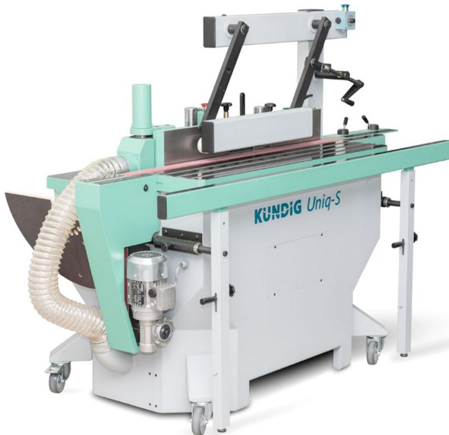
1. Les pièces sont avancées par le tapis transporteur et fixées par dessus avec des rouleaux presseurs.
