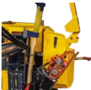
Les places pour la mise des accessoires sont à portée de main. Supports pour hache, couperet et petit couperet intégrés. Un support de scie à chaîne est également possible.
