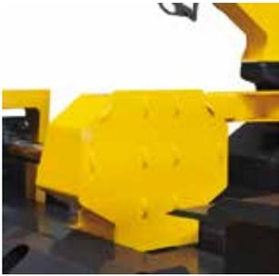
Les guides plastiques de la plaque de poussée sont faits d'un matériau spécial qui ne nécessite pas de graissage. Le guidage précis de la plaque de poussée assure une longue durée de vie.
