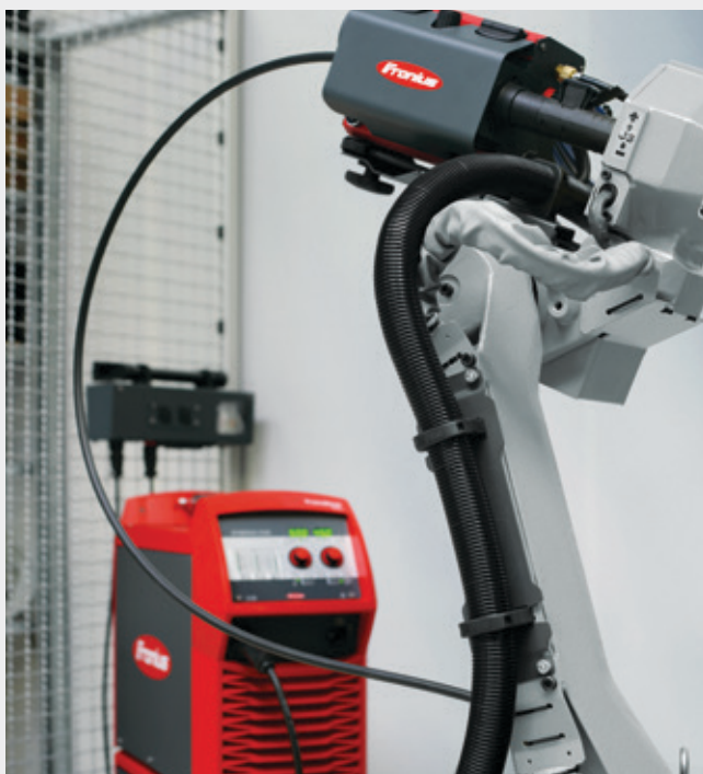
/ Structure du système TransSteel Robotics
