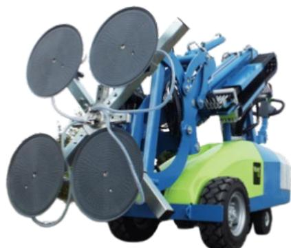
Puissant et précis, le WINLET 785 dispose de 6 fonctions hydrauliques dont le déplacement latéral et la rotation.
