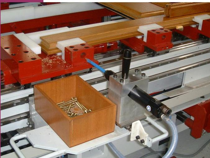
Vue de détail d'un chariot équipé d'une visseuse pour réaliser l'assemblage mécanique de la porte.
