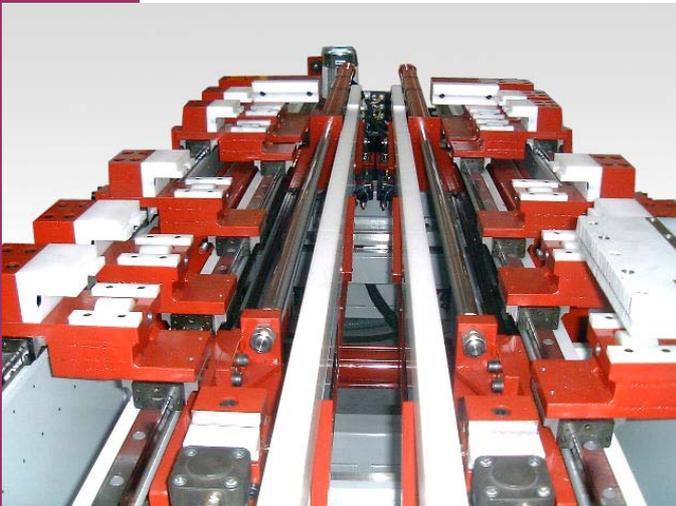
Vue de détail des 4 chariots de serrage latéral de chaque côté. Au fond 2 chariots de serrage vertical. L'évacuation des portes se fait manuellement en bout de machine.
