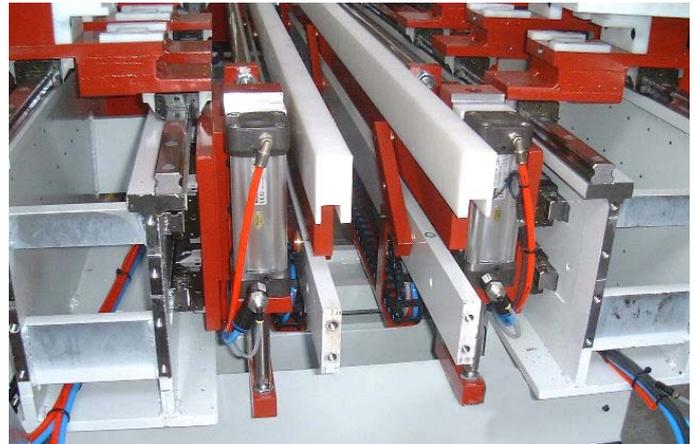
Vue de détail du système de réglés escamotables verticalement en fonction des épaisseurs des portes à cadrer.
