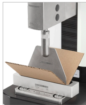
Test de pliage d'emballage
