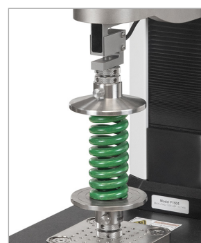
Test de compression de ressort
