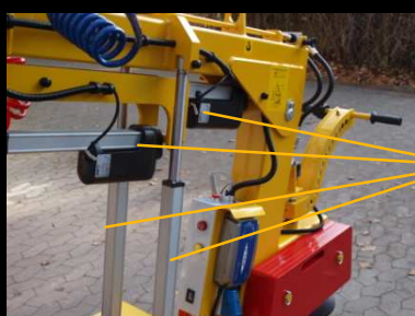
Vérins à commande électrique de 24V pour un travail sûr et précis
