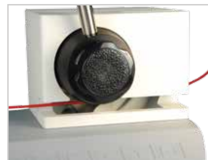
Mâchoires dentées unique pour tous les diamètres de fils, permettant de saisir l'échantillon
