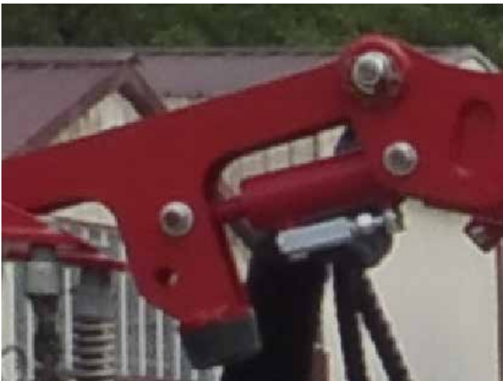
Réglage du « poignet » par vérin hydraulique
