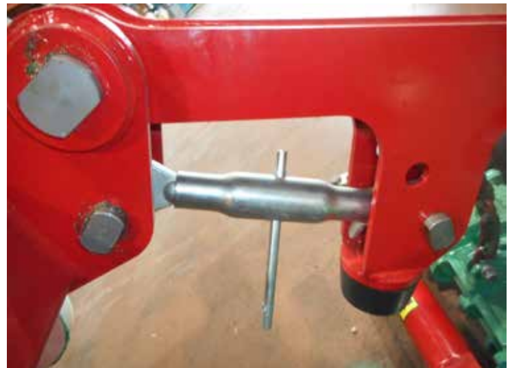
Réglage du poignet par vérin manuel
