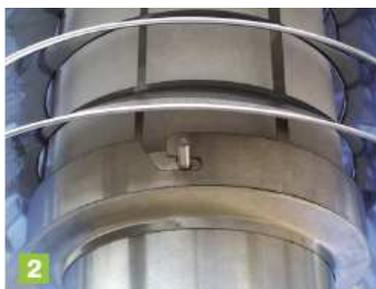
3. Le filtre est ensuite enfilé sur le support en tôle perforée. Bien vérifier que de l'air non filtré puisse être aspiré.
