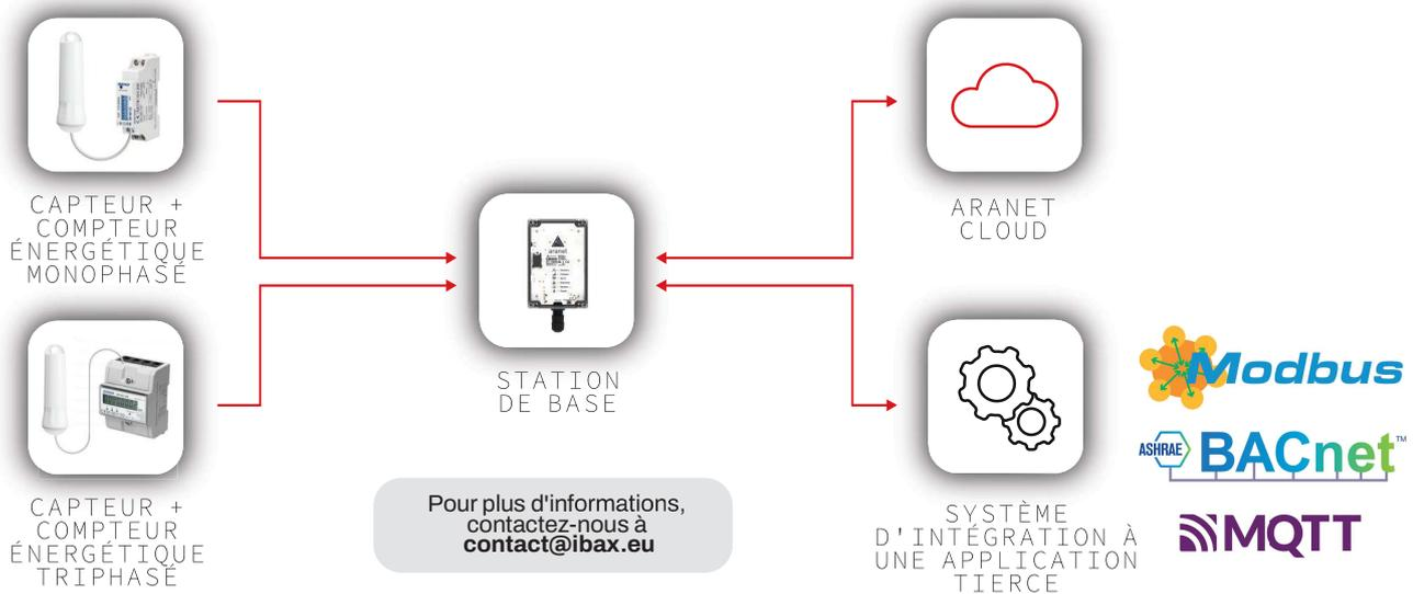
Une **base radio Aranet** combinée à un **compteur d'impulsions à contact sec** et à un compteur d'énergie **monophasé** ou **triphasé** permet de suivre facilement la consommation d'énergie électrique à distance de façon centralisée.
