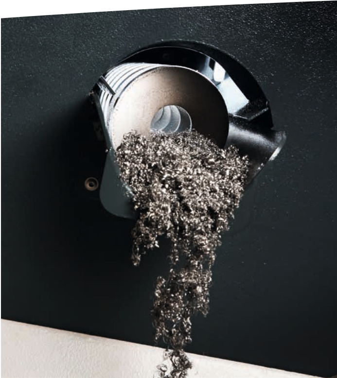
Évacuateur de copeaux (version à vis sans fin)
