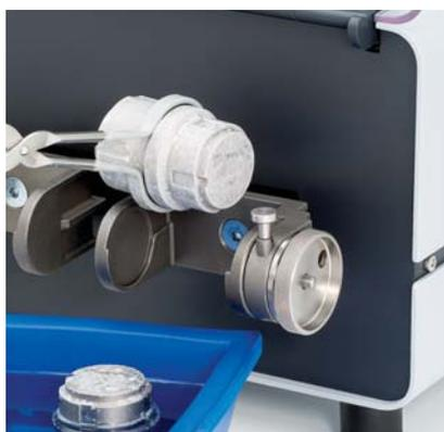
*Avant le broyage, les bols sont plongés dans de l'azote liquide (-196 °C) dans le kit cryogénie pendant 2 à 3 minutes*
