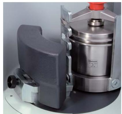
Pour un équilibrage optimal, il est possible de régler le contrepoids du PM 100 sur un rail de guidage oblique
