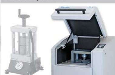
RETSCH propose différentes presses à pastiller pour la préparation d'échantillons solides pour l'analyse par fluorescence de rayons X.
