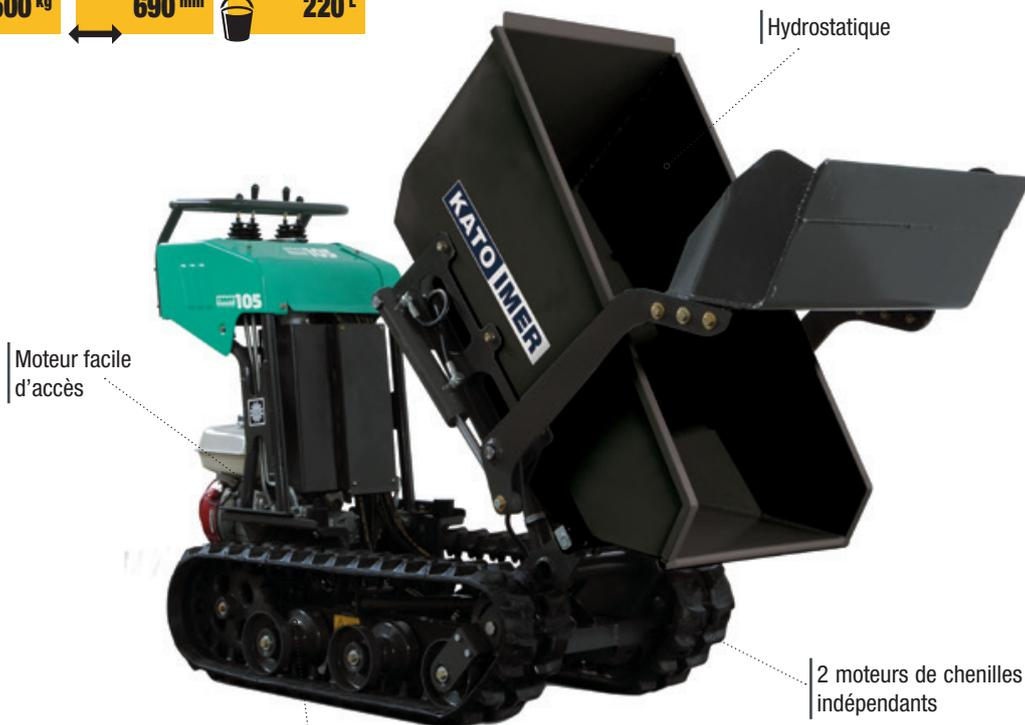
Equipée de 3 pompes qui permettent une utilisation indépendante du déchargement de la benne et de la pelle chargeuse de la traction
