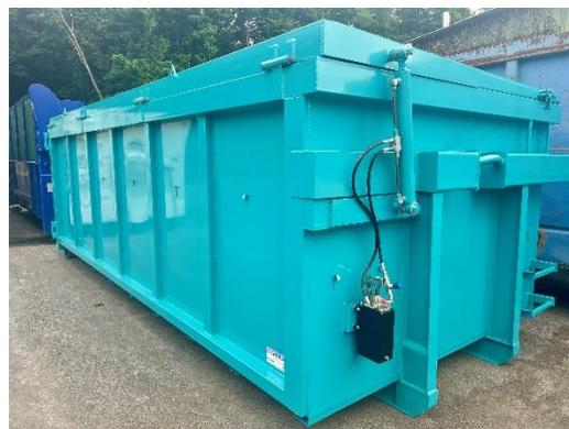
Benne 20 m<sup>3</sup> avec toit hydraulique
