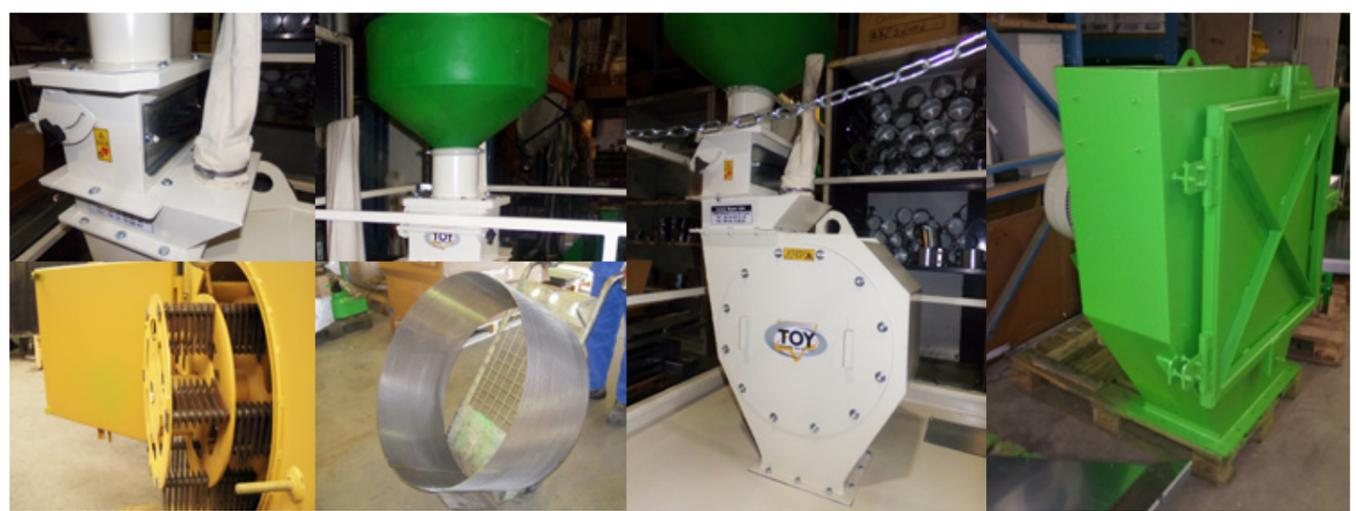
Réglage débit & manche de décompression / Rotor ETS+      Trémie rotomoulée / Grille circulaire ETS      Broyeur ETS avec boîte à aimant et manche de décompression      Broyeur ETS+ départ usine Groupe TOY
