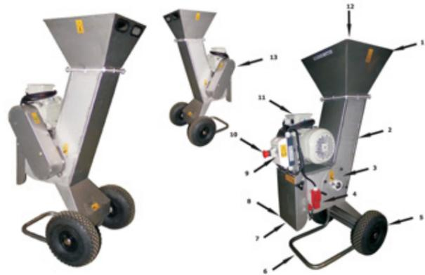
Broyeur Cadet Inox alimentaire : 1 Trémie entrée produit / 2 ossature / 3 chambre de broyage / 4 sécurité électrique / 5 Roues essieu / 6 pied / 7 grille, rabat / 8 capot / 9 marche / 10 arrêt d'urgence / 11 moteur / 12 caoutchouc anti-projection / 13 carter courroie
