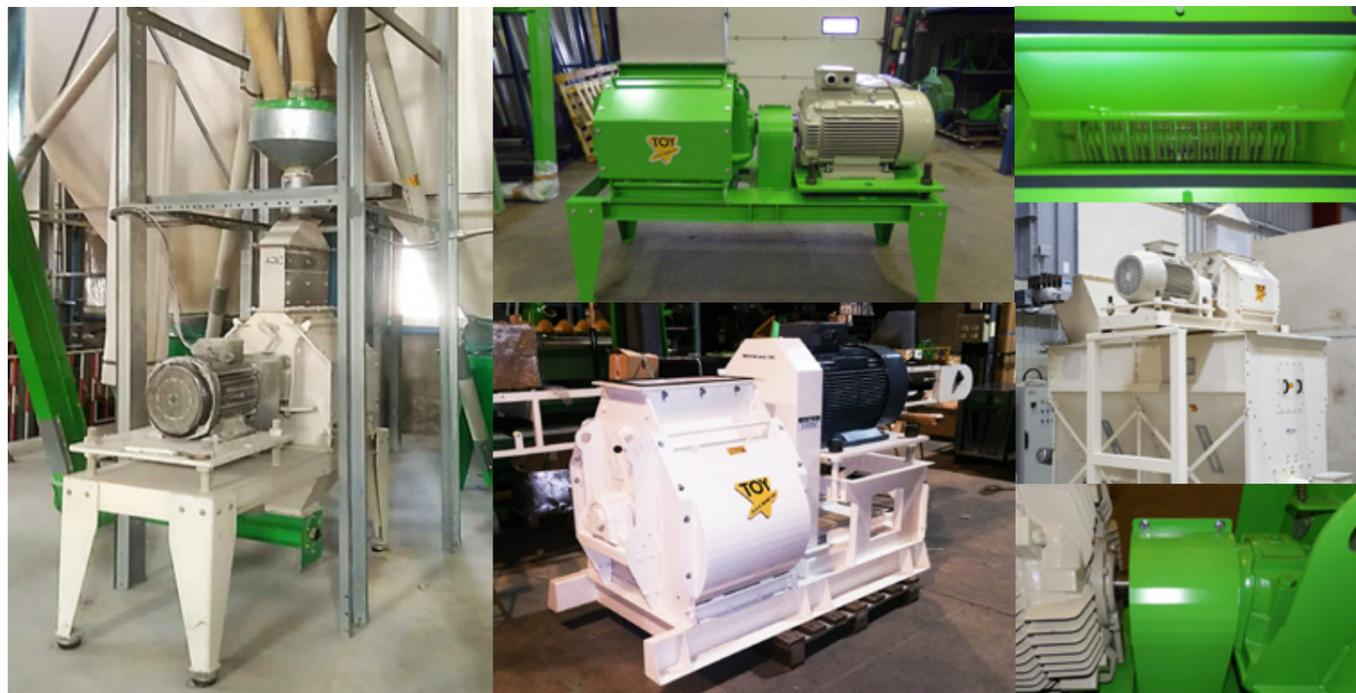
Broyeur T60NG sur pied dans usine d'aliments / Broyeur T40NG sur pied / Broyeur T80NG départ atelier Groupe TOY / Broyeur T80NG entrée produit / T60NG entraînement direct
