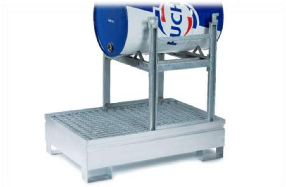
Les bacs de rétention métalliques sont robustes et économiques. Ces bacs sont en acier galvanisé à chaud et répondent ainsi en outre à un usage prolongé à l'extérieur. Le MINIMCT/H-C est conçu pour le stockage en rétention de deux fûts de 220 litres, et, est équipé d'un caillebotis renforcé.
