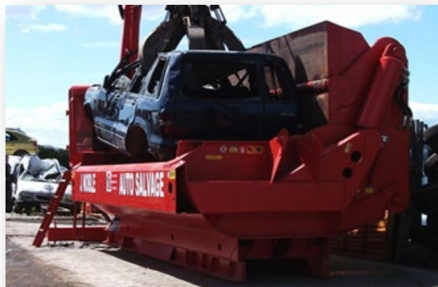
Chargement des VHU au grappin intégré
