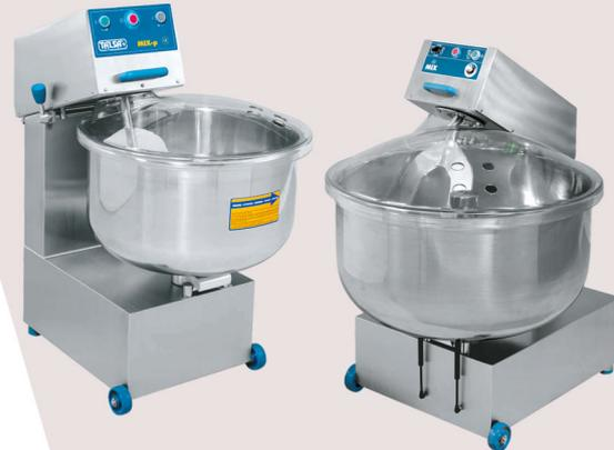
Modèles P-professionnel (2 moteurs) : Cuve motorisée • Commande et inversion du sens de rotation du bras par boutons poussoir permettant un pétrissage plus intense en moins de temps, même avec de faibles quantités • Boîtier électrique étanche à basse tension de sécurité.
