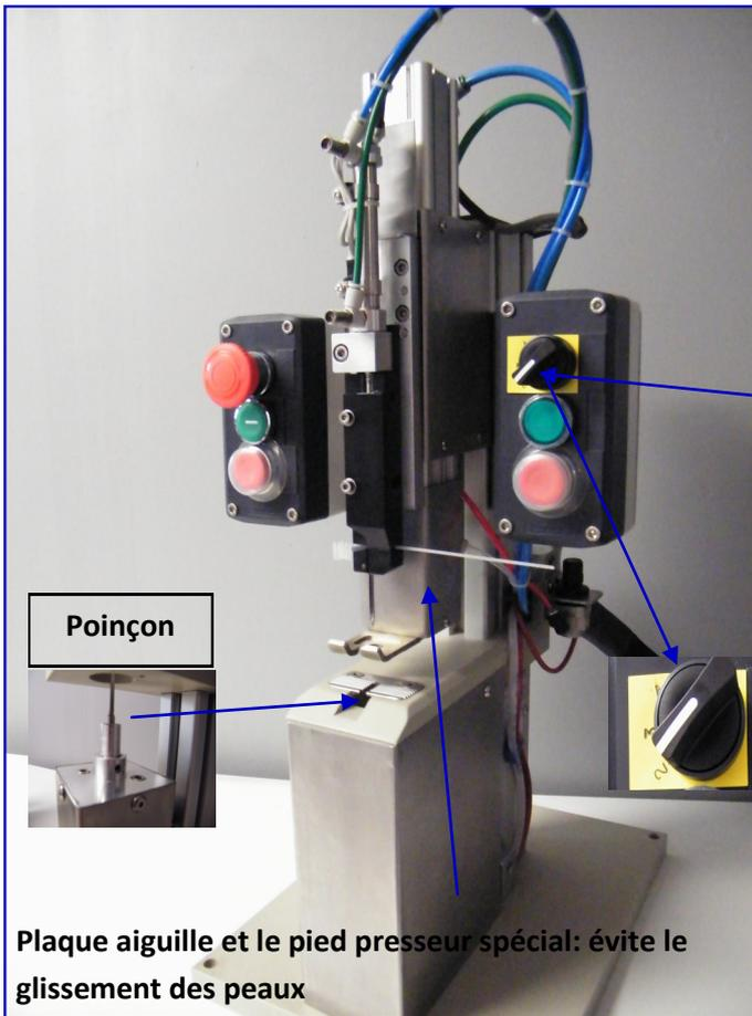
Cette machine est très robuste (étanche) et est conçu pour fonctionner au sein du cycle de traitement des peaux de reptiles ou autres..
