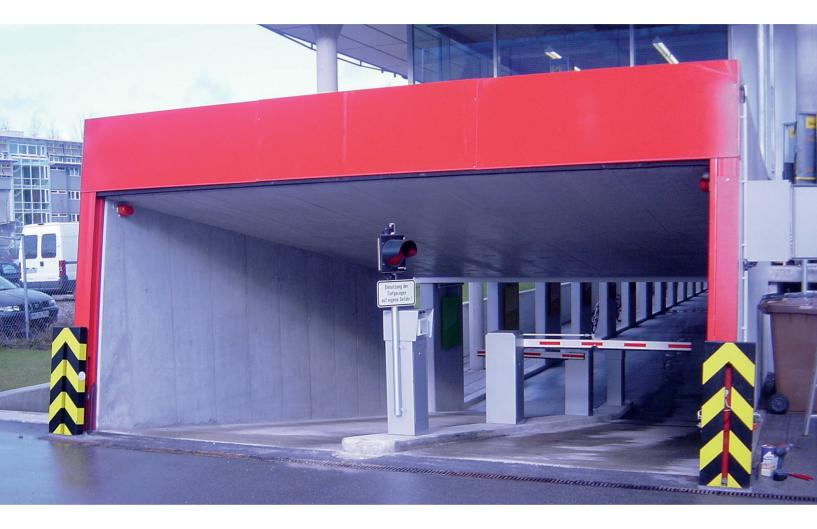
Cette barrière de rétention pneumatique/automatique certifiée TUV et V.d.S. est tenue dans sa position de repos par un cylindrique pneumatique, au-dessus de l'ouverture de porte. Deux profilés en U sont placés à gauche et à droite le long des côtés du portail dans lequel la barrière se déplace.
