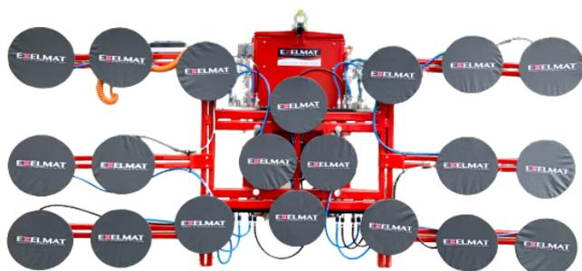
La conception robuste du DSMH2 et son système composé notamment de 2 circuits de vide conformément à la norme EN13155 en font un palonnier d'utilisation facile et très efficace. L'équipement est pourvu de témoins visuels et sonores et d'une gestion automatique du vide d'air en cas de manque ou de perte. La position des ventouses est réglable en hauteur ou en largeur pour les rallonges. Elles sont déconnectables par raccord pneumatique rapide.
