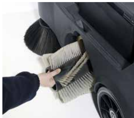
Aucun outil nécessaire pour le réglage des brosses ni pour le remplacement du filtre
