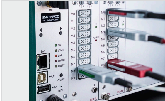
Connexions des capteurs ALMEMO® et pour la mise en réseau (témoin d'état OLED)
