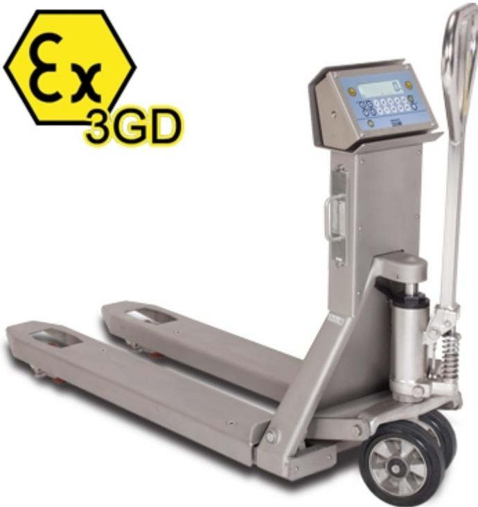
Transpalette manuel avec électronique de pesage pour zones dangereuses classées à risques d'explosions (zone 2 et 22) selon les normes ATEX Ex II 3GD IIC T6 T130°C X. Equipé de 4 capteurs ATEX en acier INOX étanches IP68, garantissant une précision dans toutes les conditions de travail. Structure entièrement en acier inoxydable. Disponible également en UR pour la transaction commerciale CE-M.
