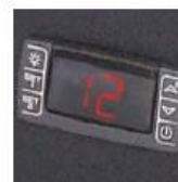
Thermostat de réglage de la température avec écran numérique. Après avoir défini la température, le réglage se fait de manière électronique.
