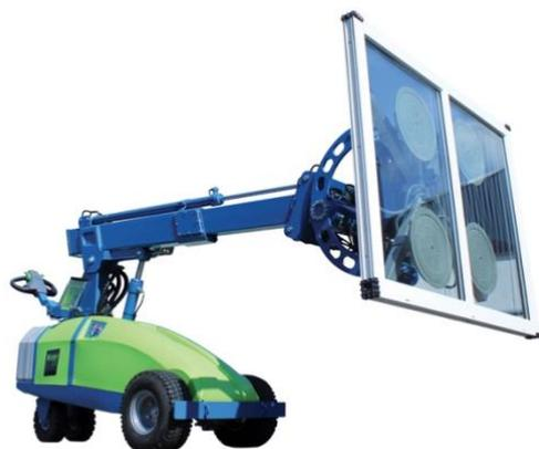
Puissant et précis, le WINLET 575 dispose de 6 fonctions hydrauliques dont le déplacement latéral et la rotation. Sa tête porte ventouse bascule à 180° lui permettant un retournement complet des panneaux, utile pour l'atelier. Il possède une fonction "gyroscopique" qui garantit le maintien automatique des panneaux dans la même position lorsque la pièce est levée avec le bras principal.
