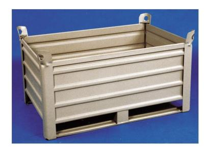
Caisse-palette métallique en tôle nervurée avec 2 semelles. Elingable. Fond : 2 mm - Parois : 1,5 mm - Cornières d'angles : 4 mm
