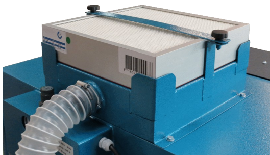
Filtration absolue HEPA 13 HEPA Capable de filtrer au moins 99,95% des particules supérieures ou égales à 0,3µm.
