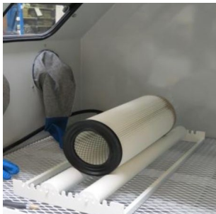
Berceau à rouleaux SUP 1 Permet de tourner les filtres plus aisément lors du soufflage.
