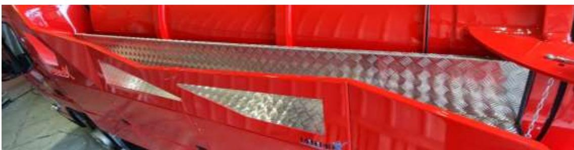
Nous mettons en place des tôles de protection aux endroits les plus exposés (citerne, barre anti-encastrément, etc..)
