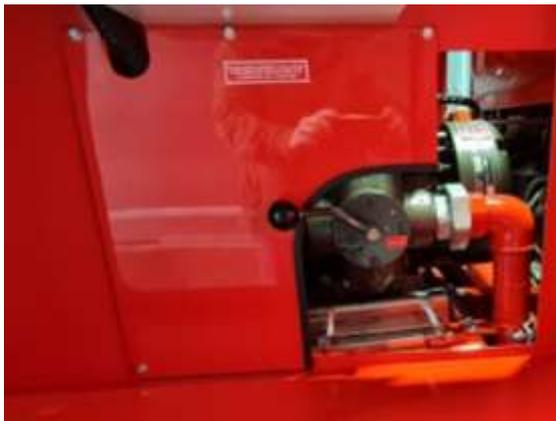
Accès facilités aux pompes et mécaniques pour l'entretien, les niveaux et les contrôles (tôles boulonnées démontables, cabine basculante, etc..)
