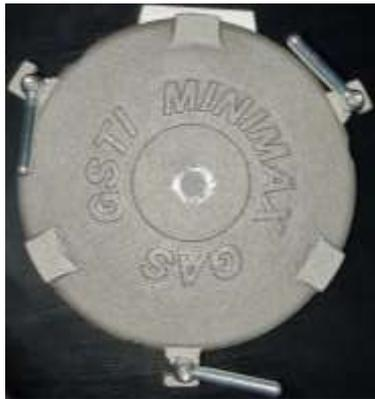
Le réservoir de sécurité et le filtre à air viennent terminer de protéger la pompe à vide contre l'intrusion de produit.
