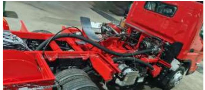
Elément structurel porteur de l'équipement, le faux châssis est l'interface entre le véhicule et l'installation. Il est fabriqué en matériau de haute qualité et est monté conformément aux règles de carrossage fixées par le fabricant du châssis
