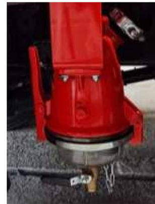
L'échappement de la pompe à vide se fait au travers du silencieux déshuileur qui permet d'atténuer le bruit et de récupérer et canaliser les huiles de graissage de la pompe.
