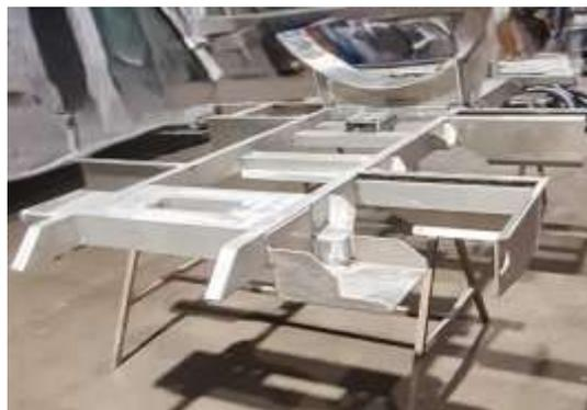
La citerne est fixée mécaniquement en trois points au faux châssis
