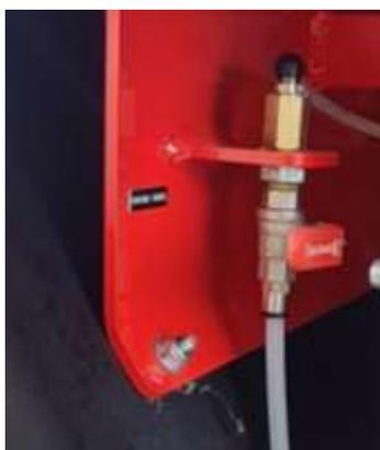
Une vanne accessible permettant le nettoyage de la pompe à vide est mise en place.
