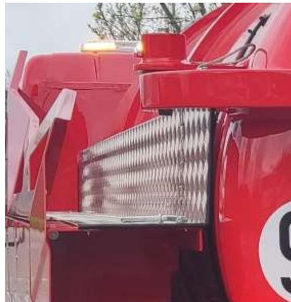
Mise en place de tôles pour la protection de la citerne et des coffres
