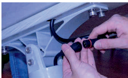
5. Connectez le panneau solaire et le support horizontal via le connecteur 4 points.
