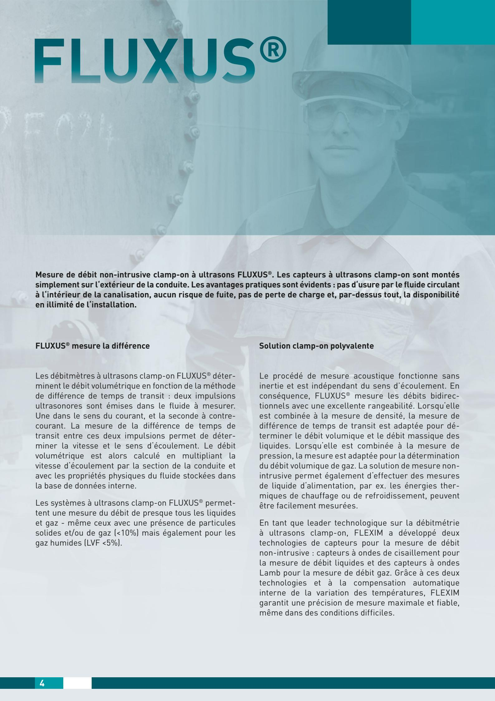
**Mesure de débit non-intrusive clamp-on à ultrasons FLUXUS®.** Les capteurs à ultrasons clamp-on sont montés simplement sur l'extérieur de la conduite. Les avantages pratiques sont évidents : pas d'usure par le fluide circulant à l'intérieur de la canalisation, aucun risque de fuite, pas de perte de charge et, par-dessus tout, la disponibilité en illimité de l'installation.
