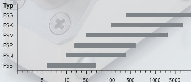
Diamètre intérieur du tube en mm
