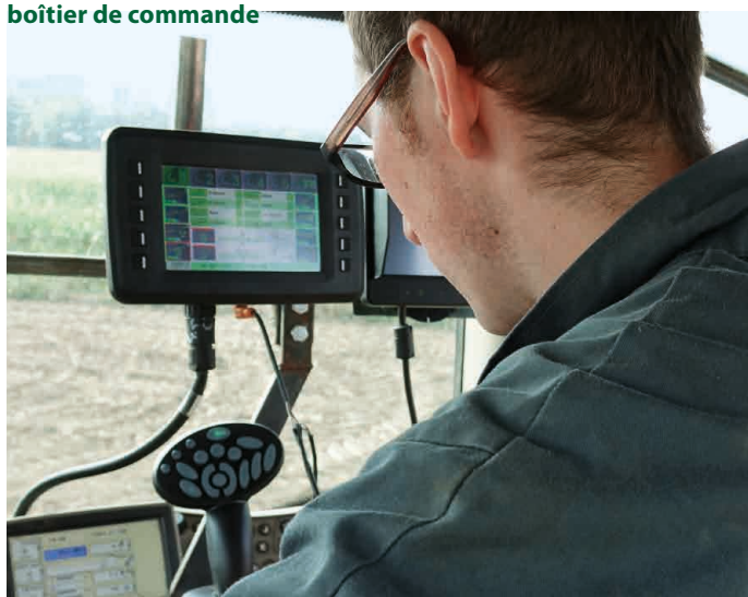
■ Fonctionnement du bus-CAN avec le joystick et le boîtier de commande
