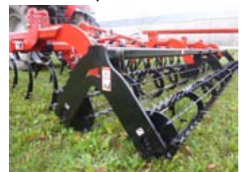
Double rouleaux crénées Ø 400/310 Palier Ø 50 8 plat 40x8
