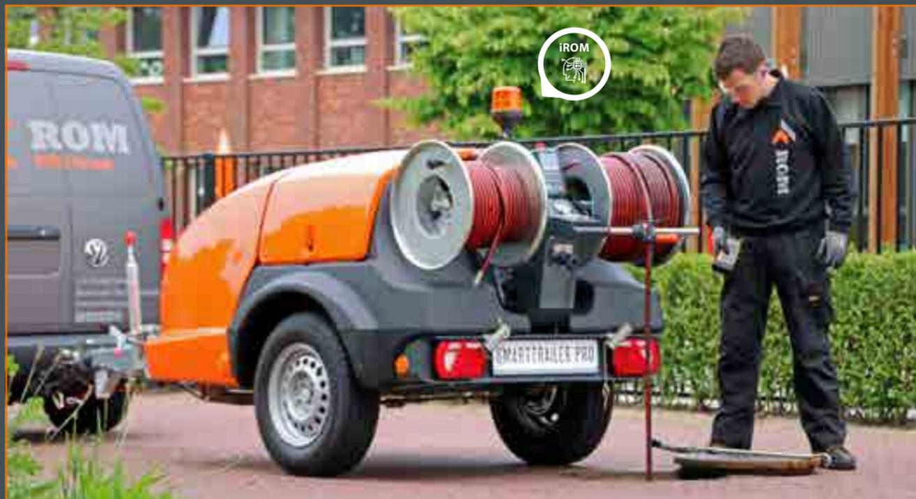
La nouvelle ROM SmartTrailer PRO remorque de curage d'égouts à haute pression est emballée avec plusieurs solutions intelligentes basées sur plus de 39 ans d'expérience. Idéale pour déboucher et nettoyer des raccordements domestiques et l'égout principal jusqu'à un diamètre de Ø400 mm. Vous pouvez choisir entre un moteur à essence ou un moteur Gazole, une pression de nettoyage jusqu'à max. 200 bar et une capacité d'eau jusqu'à max 60 l/min.
