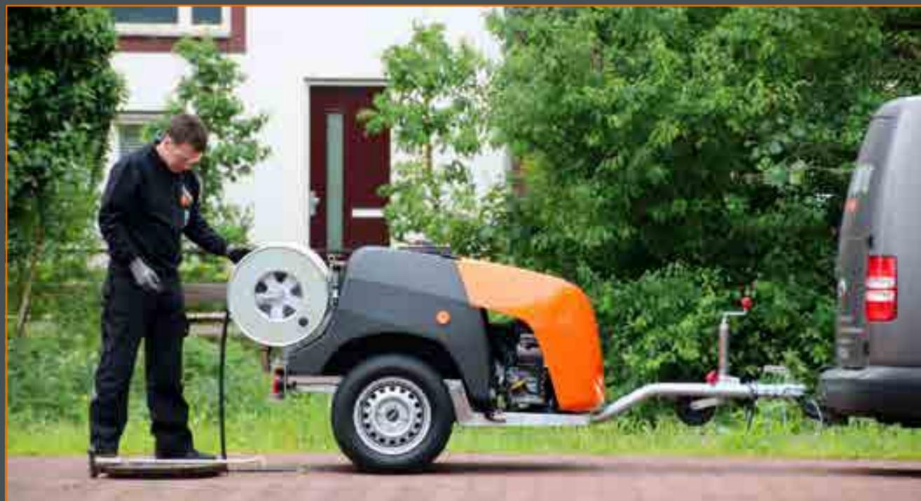
La ROM SmartTrailer remorque de curage d'égouts se destine au débouchage et au curage de raccordements domestiques et de l'égout principal jusqu'à un diamètre de Ø300 mm. La machine convient également au nettoyage de façades, de surfaces et de conduites. La remorque peut même être utilisée pour l'élimination de graffitis superficiels. La solution parfaite pour des égoutiers, des entreprises d'installation, des plombiers et des municipalités.
