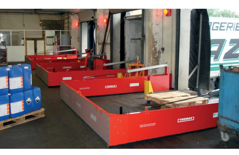
Cette barrière de rétention entièrement automatique certifiée TUV et V.d.S. est construite en forme de U, ce qui la rend idéale pour une utilisation sur les quais de déchargement. La barrière est située en repos à côté et au-dessus de l'ouverture de la porte. Le corps de la barrière est maintenu en position verticale à l'aide de deux vérins pneumatiques.
