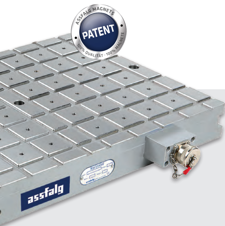
☛ Magnaslot 400 × 600 mm : HD-Version, max. nombre de pôles sur la surface de serrage, ici 48 x P50
