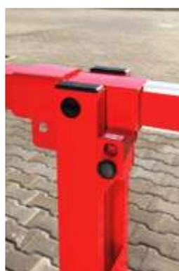
Robuste système de barrière levante manuelle avec contrepoids et poigné d'appui composée d' 1 poteau principal de largeur 100 x 220 mm, à cheviller sur platine dim. 265 x 265 mm, d'1 lisse de section XL 90 x 60 mm, longueur au choix et d'1 poteau de repos à cheviller sur platine 200 x 200 mm. Hauteur 1000 mm. Poids de 110 à 175 kg
