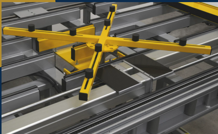
*Croix centrale déplaçable en position avant avec bridage pneumatique automatique pour le vitrage des châssis*
