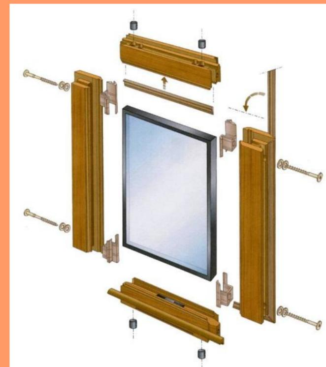
Exemple de menuiserie à assemblage mécanique utilisant la technique de vis avec insert qui rend la menuiserie démontable. Une pièce défectueuse ou le vitrage peut être changé par exemple.
