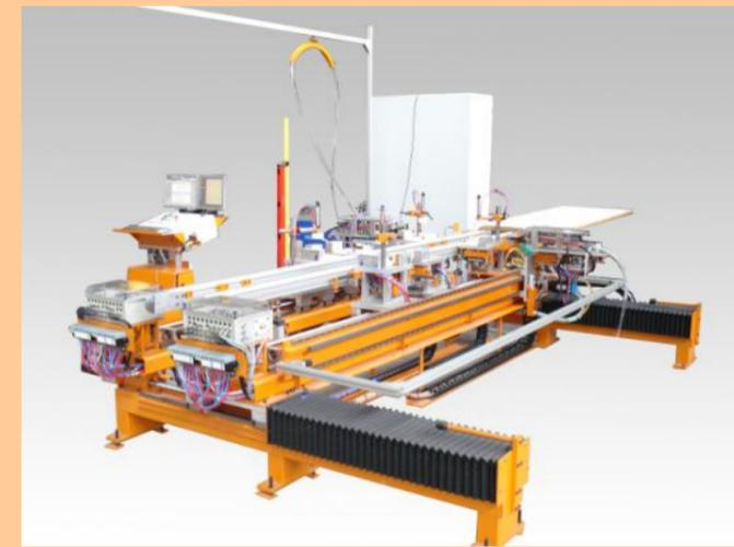
Cadreuse visseuse horizontale avec évacuation automatique en ligne des menuiseries.
