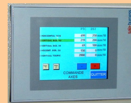
Ecran tactile (jusqu'à 7 axes pilotés)
