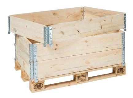
Les rehausses pliantes en bois sont fabriquées en bois résineux surfacé et chanfreiné. Les rehausses sont adaptées aux préparations de commande ainsi qu'aux transports navettes : Elles sont pliables donc économie de fret retour. Hauteur de prise : 30 mm Rivetage électrique : 8 rivets par charnières
