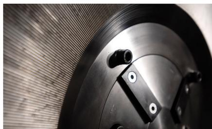
Les microniseurs ZERMA PM peuvent être équipés de 2 disques de coupe ou de segments, les deux sont fabriqués en acier de qualité et l'outil peut être traité pour résister plus longtemps à l'usure.
