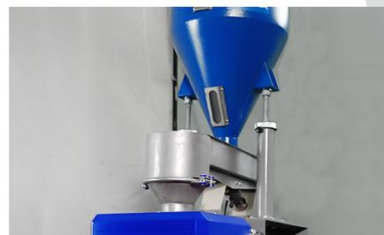
Le matériau est introduit dans le microniseur par un couloir vibrant de dosage, l'alimentation est automatiquement ajustée en fonction de l'ampérage des moteurs et de la température de process.
