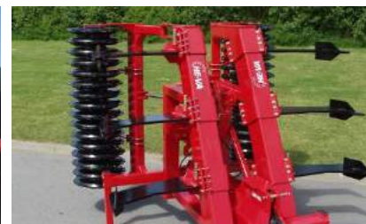
4,00 m avec repliage hydr., 7 dents, anneaux V-profil et sécurité boulons Quick-push
