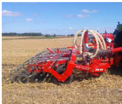
4,00 m avec repliage hydr., 7 dents, anneaux V-profil et sécurité boulons Quick-push
