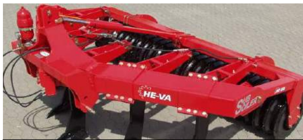
3,00 m rigide, 5 dents, avec anneaux V-profil et sécurité automatique hydraulique
