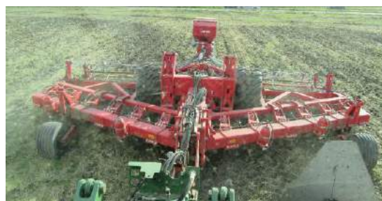
7,00m avec repliage hydr. 13 dents, anneaux V-profil, sécurité automatique hydr.
