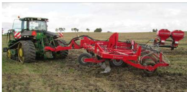
7,00 m avec repliage hydr., 13 dents, anneaux V-profil, sécurité automatique hydr.
