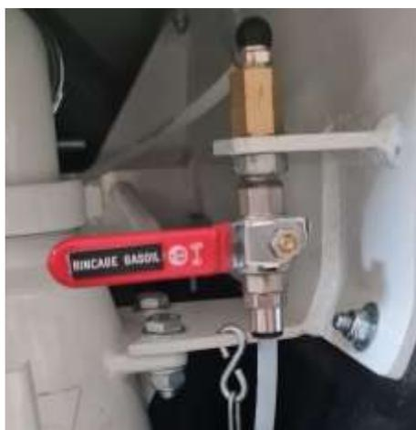
Une vanne accessible permettant le nettoyage de la pompe à vide est mise en place.
