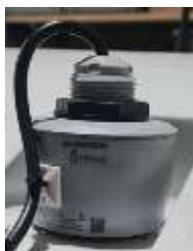
Le niveau est mesuré par un radar monté sur la citerne et est affiché au tableau. Une sécurité coupe la pompe à vide au niveau haut.
