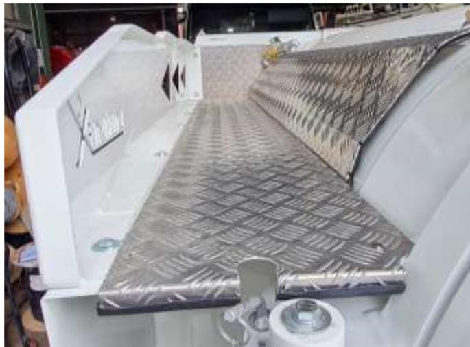
Mise en place de tôles pour la protection de la citerne et des coffres
