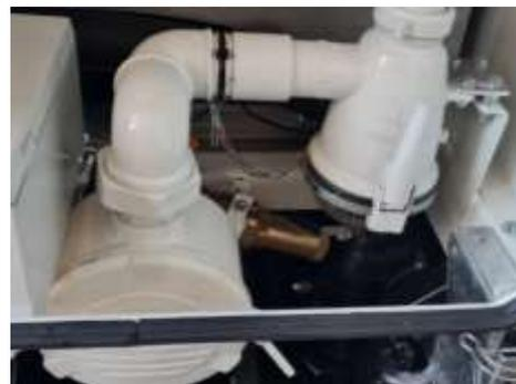
La commande de la vanne quatre voies de la pompe à vide permettant l'aspiration ou le refoulement est motorisée électriquement.
