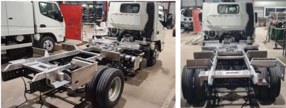
Élément structurel porteur de l'équipement, le faux châssis est l'interface entre le véhicule et l'installation. Il est fabriqué en matériau de haute qualité et est monté conformément aux règles de carrossage fixées par le fabricant du châssis
