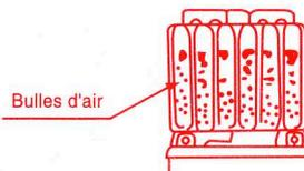
Note: S'il n'y a pas de bulles d'air dans l'un des trois orifices de remplissage du côté droit ou du côté gauche, tapoter deux ou trois fois le bas du récipient. Ne jamais retirer le récipient de la batterie
