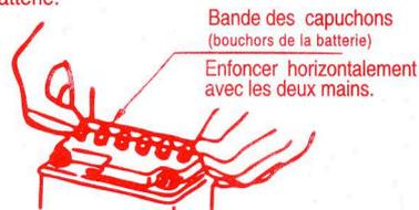
La procédure de remplissage est maintenant terminée. Ne jamais retirer la bande des capuchons ni ajouter de l'eau ou de l'électrolyte
