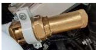
**Deux soupapes** de sécurité, tarées et plombées, assurent la sécurité des opérateurs. **Une sur le circuit et une sur la citerne, en amont et en aval de la vanne d'isolement.**
