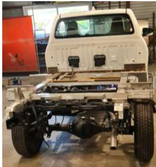
Elément structurel porteur de l'équipement, le faux châssis est l'interface entre le véhicule et l'installation. Il est fabriqué en matériau de haute qualité et est monté conformément aux règles de carrossage fixées par le fabricant du châssis
