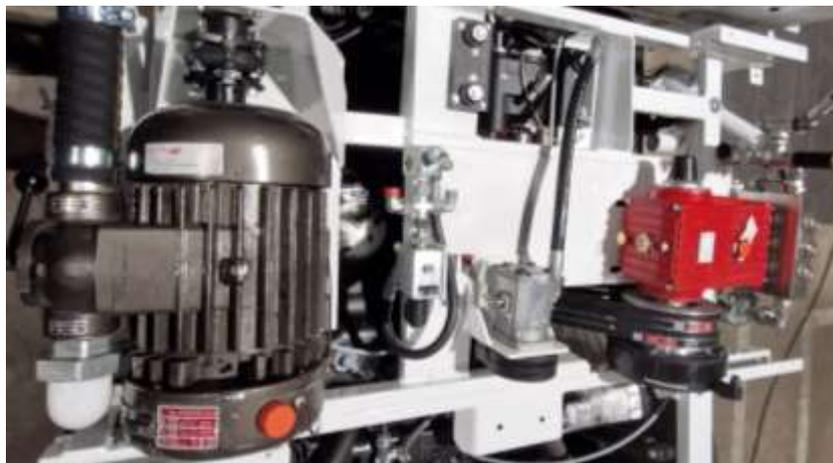
La transmission de la puissance est assurée par poulies, courroies et embrayage électromagnétique pour la pompe haute pression et hydrostatique pour la pompe à vide
