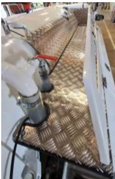
Mise en place de tôles pour la protection de la citerne et des coffres
