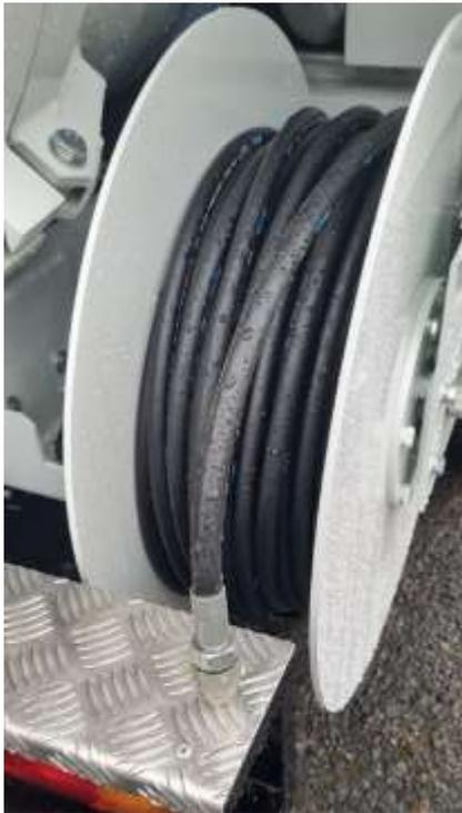
Des fixations sont positionnées pour permettre un blocage aisé des raccords des flexibles une fois enroulés sur leur dévidoir.
