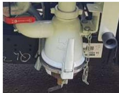
L'échappement de la pompe à vide se fait au travers du silencieux déshuileur qui permet d'atténuer le bruit et de récupérer et canaliser les huiles de graissage de la pompe.
