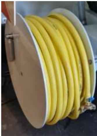
Remplissage de la réserve d'eau sur un robinet par l'intermédiaire de l'enrouleur de remplissage et de l'électrovanne permettant un branchement en continu
