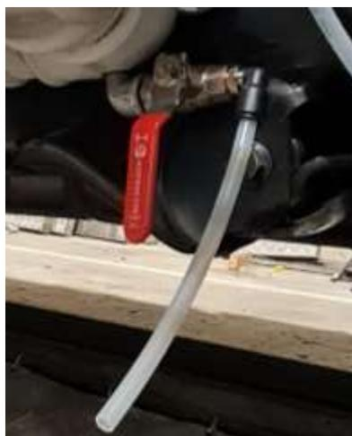
Une vanne accessible permettant le nettoyage de la pompe à vide est mise en place.
