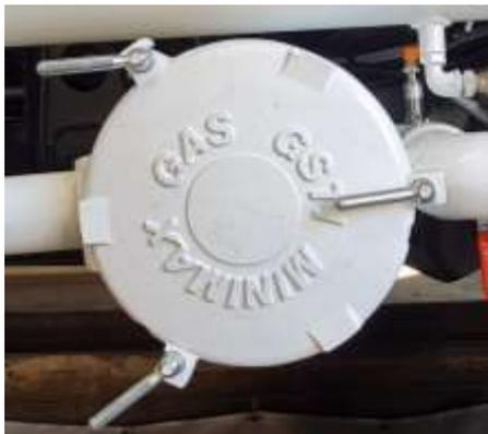
Le réservoir de sécurité et le filtre à air viennent terminer de protéger la pompe à vide contre l'intrusion de produit.
