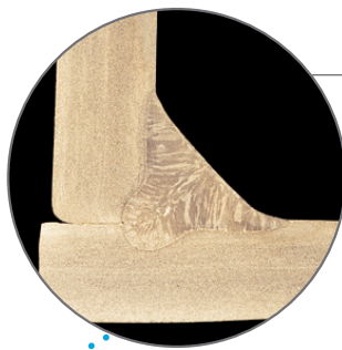
Soudure d'angle en MAG avec Inomaxx Plus Tôle acier inoxydable AISI 316L épaisseur 6mm
